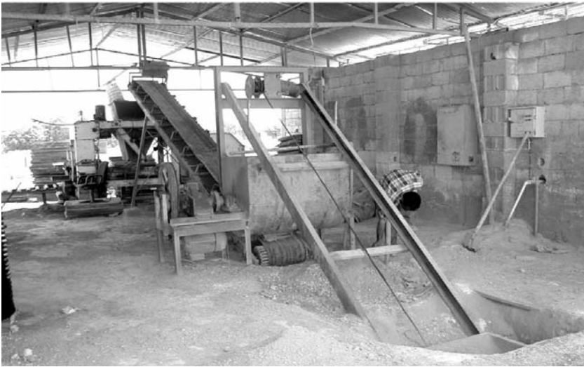
Resim.49-50. URFA'da Pilot Yapı İnşaatı İçin Alker Blok İmalatı, Ekim 1999
