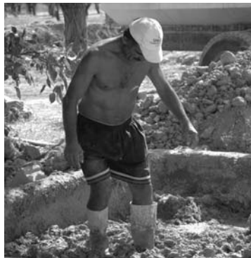
Resim.21, 22, 23 geleneksel kerpiç üretimi: havuz, ayakla ezme, kerpiç kesme(Özbekoğlu)
