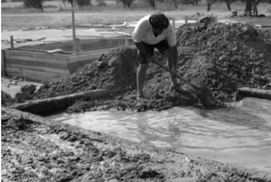
Resim.21, 22, 23 geleneksel kerpiç üretimi: havuz, ayakla ezme, kerpiç kesme(Özbekoğlu)
